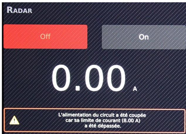
*Exemple d'un circuit "Radar" ayant disjoncté, car le courant consommé par le circuit a dépassé la limite configurée de 8A*
