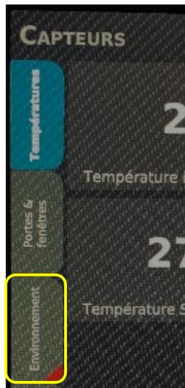
En cliquant sur le bouton CAPTEURS, la page correspondant à l'onglet "Températures" est affichée. Mais c'est l'onglet "Environnement" qui est marqué en rouge, indiquant que c'est dans celui-ci qu'une alarme a été déclenchée.
